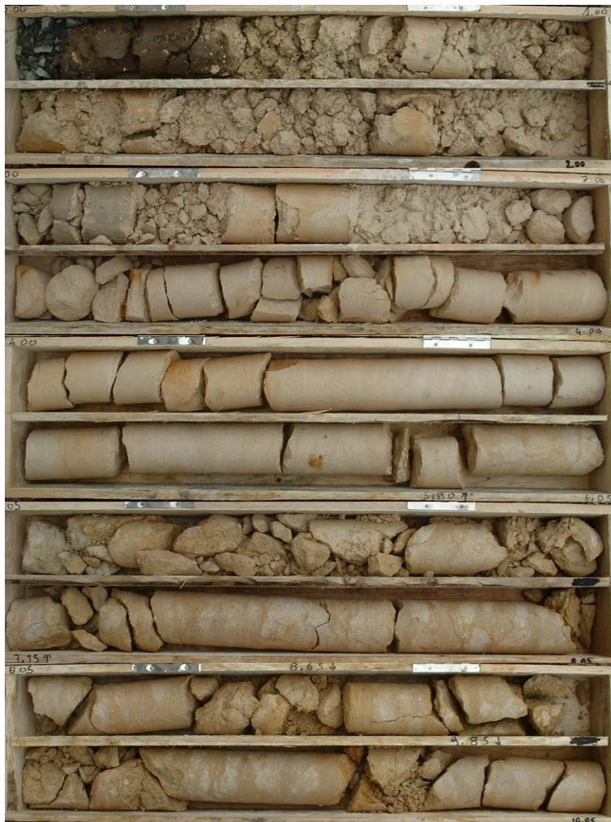
Figure 14 : Exemple de caisses de récupération de carottes
