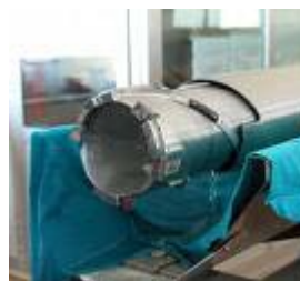
Figure 13 : Exemple de sondeuse pour une campagne de reconnaissance et d'un carottier
