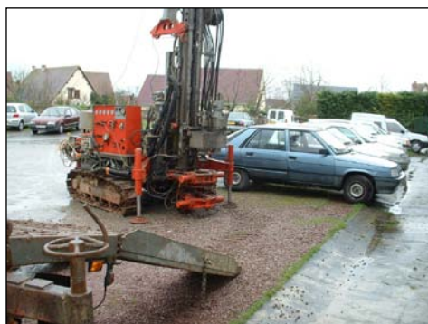
Figure 13 : Exemple de sondeuse pour une campagne de reconnaissance et d'un carottier
