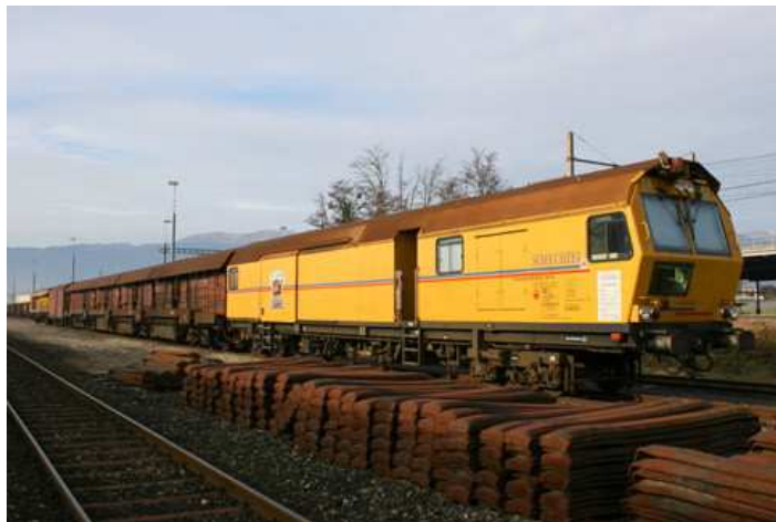
Figure 11 : Train meuleur de rails (Scheuchzer, S.A.), source : SNCF Réseau
