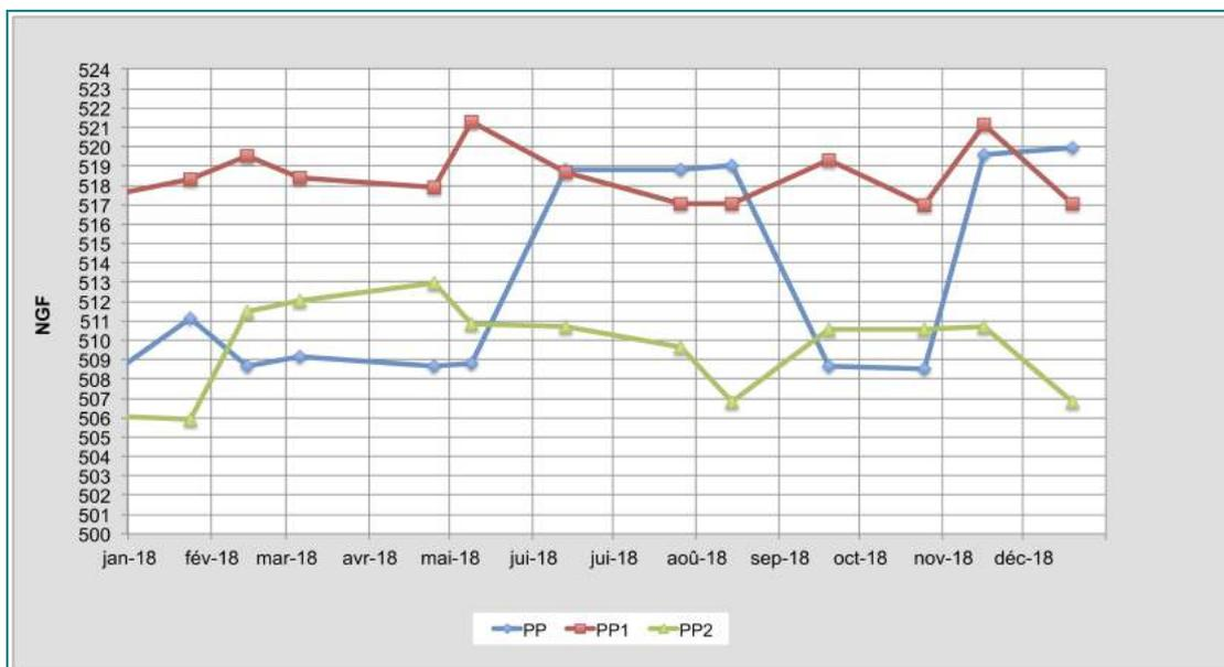
Les niveaux mesurés sont directement en lien avec les niveaux de déclenchement des pompes. Les remontées parfois observées sur plusieurs mètres correspondent à des périodes de pannes ou de maintenance sur les pompes (exemple de PP au cours de l'été et en fin d'année).
