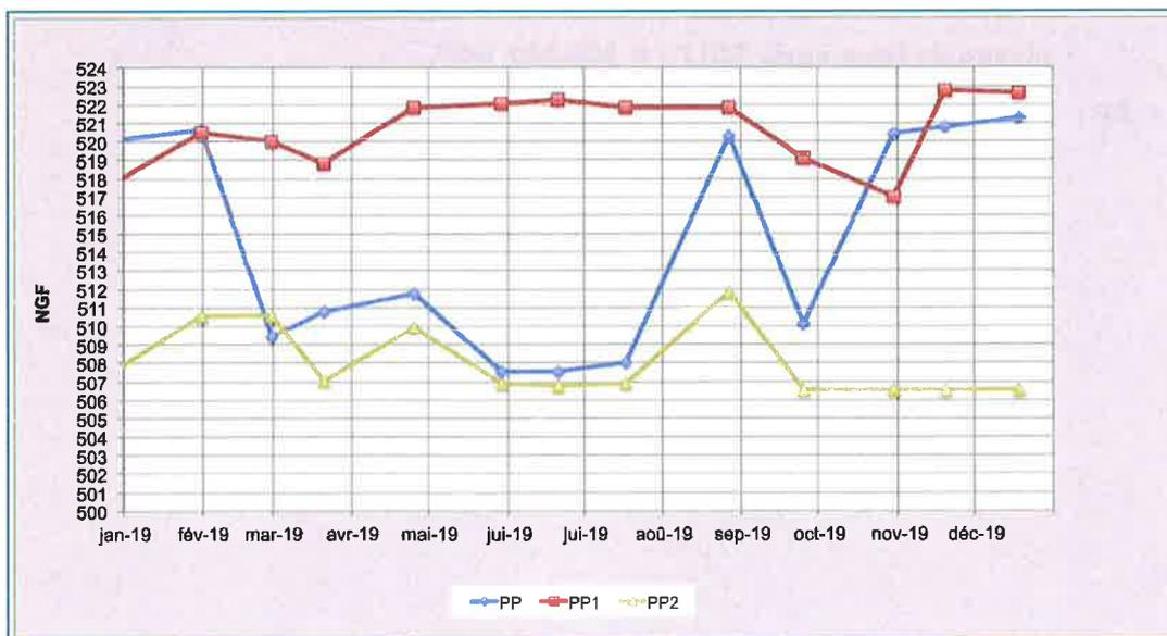
Les niveaux mesurés sont directement en lien avec les niveaux de déclenchement des pompes. Les remontées parfois observées sur plusieurs mètres correspondent à des périodes de pannes ou de maintenance sur les pompes.
